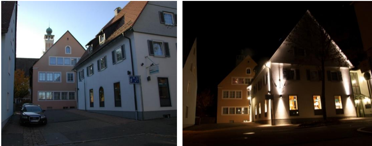
Abb. 48: a / b: Typische Bestandssituation: Diese Architekturbeleuchtung dient weder dem Stadtbild noch der Orientierung, Tag- und Nachtbild stehen in keiner Beziehung zu einander.
