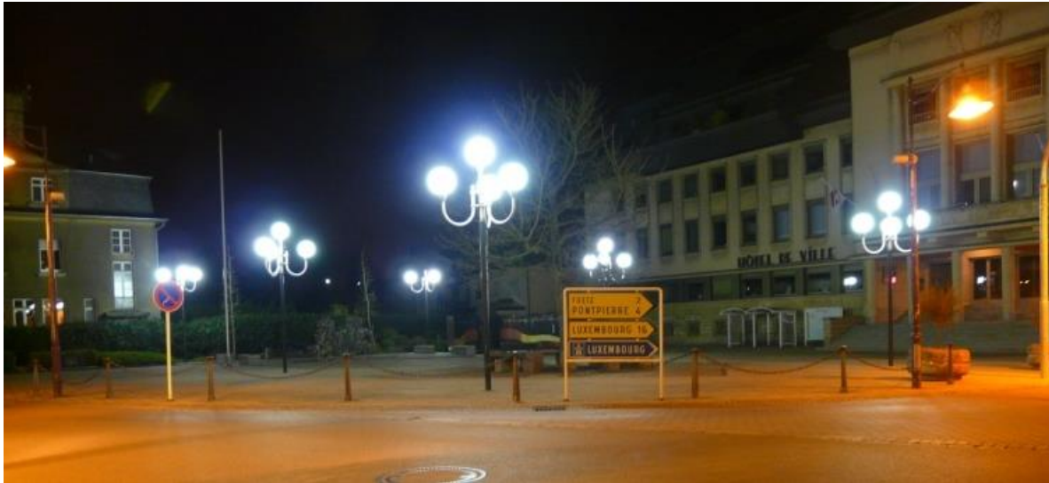
Abb. 27: Kugelleuchten strahlen das Licht diffus in alle Richtungen ab. Das Auge fokussiert auf die hohe, sichtbare Leuchtdichte und setzt die Erkennbarkeit der Umgebung herab.
