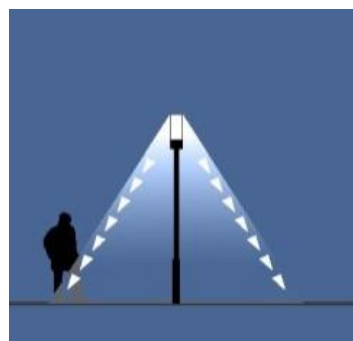
Abb. 36: Lichtpunkthöhen zum Insektenschutz reduzieren sofern nur im wirtschaftlichen/grünräumlichen Zusammenhang möglich und sinnvoll.
